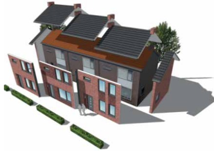
Gevelrenovatie (Bron: Nederlandse Bouw Unie)
