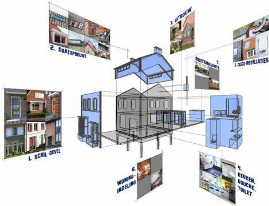
FIGUUR 1.4 Componentrenovatie (Bron: Bouwhulpgroep)
