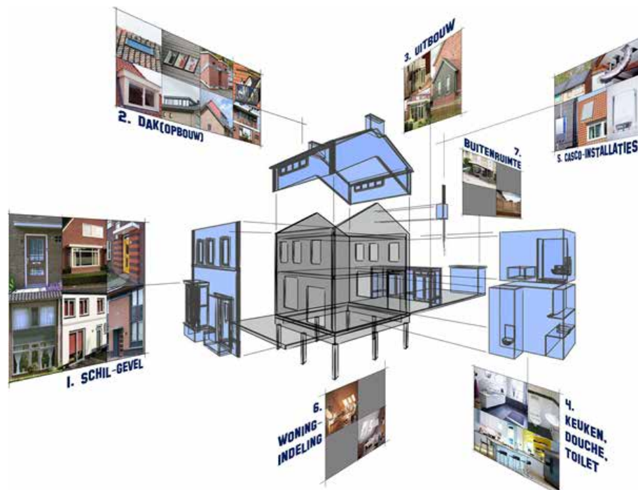
FIGUUR 2.23 Componentrenovatie (Bron: Bouwhulpgroep, 2015)
