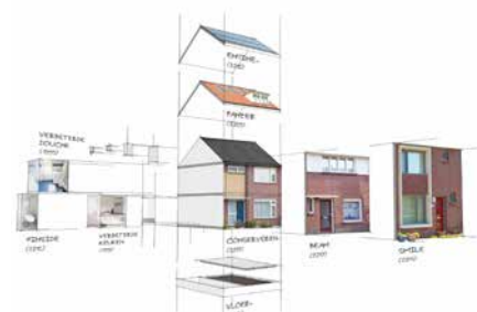
Componentenrenovatie (Bron: Bouwhulpgroep)
